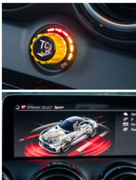
De wagendynamische elektronica is vergaand te personaliseren, zoals de negenvoudig instelbare traction control.
